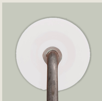
Цанга в заглушке. Две заглушки с двумя цангами отлично держат ролик на бюгеле.
